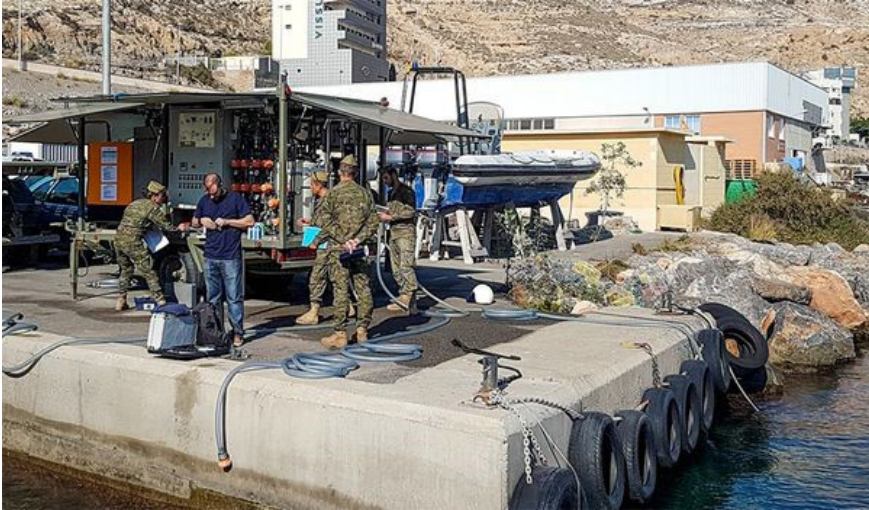
Figura 5. Potabilizadora SETA. Fuente: Jornadas de actualización sobre potabilización de agua de los zapadores de la BRI II - Ejército de Tierra (defensa.gob.es)
