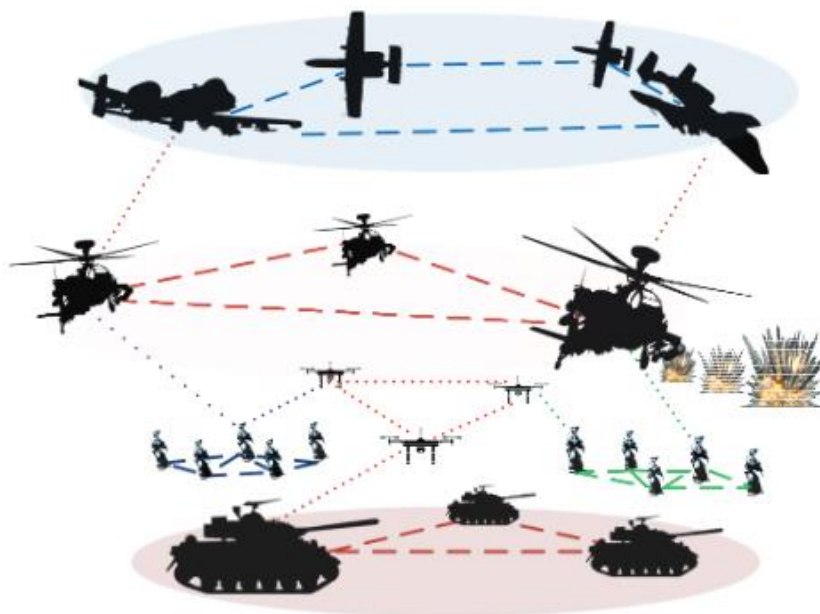
Figura 2. Ejemplo de red loBT ad hoc multicapa. Fuente: Fragkou et al. (2022)
