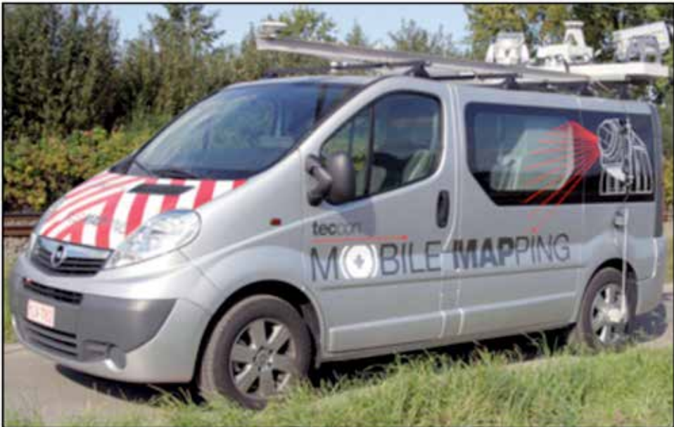
Figura 3. — La combinación de GPS con sensores de toda índole embarcados sobre diferentes plataformas (en la foto, lidar-3D sobre un vehículo terrestre) facilita la obtención de mapas de muy alta resolución en un tiempo mínimo.
