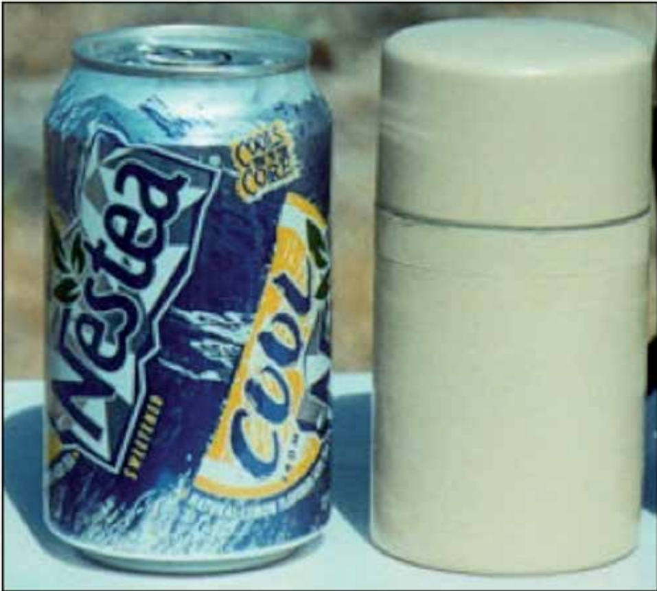
Figura 1.— La famosa «lata de soda» construida por el Centro de Pruebas de Armas Navales de China Lake. Este dispositivo de tan sólo un watt puede anular la recepción de señales GPS para la mayor parte de los receptores civiles a línea de vista. Fotografía cortesía de la Oficina Conjunta del Programa GPS.
