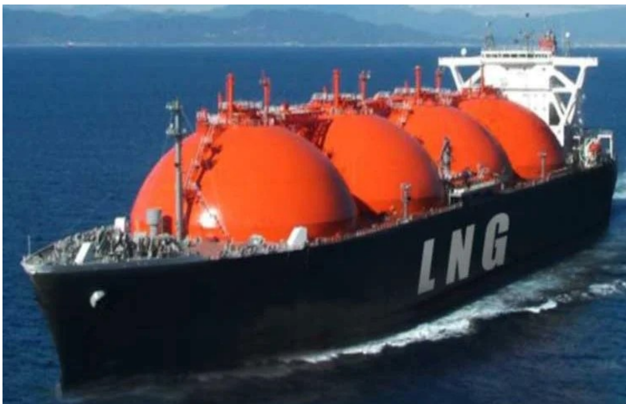
Foto nº 3. Este es el clásico buque transportador de Gas Natural Licuado. Fuente: Ingasing.
