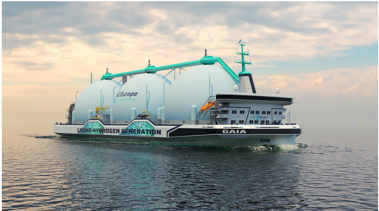
Foto nº 12. Futuro buque de hidrógeno GAIA. Fuente: C-Job Naval Architects
