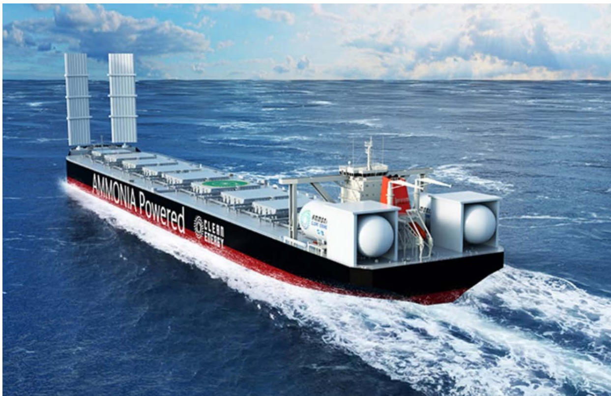
. Foto nº 4. Prototipo de buque propulsado con amoníaco con depósitos en cubierta y velas solares. Fuente: #destacadas , ambiente y ecología integral , industrial naval
