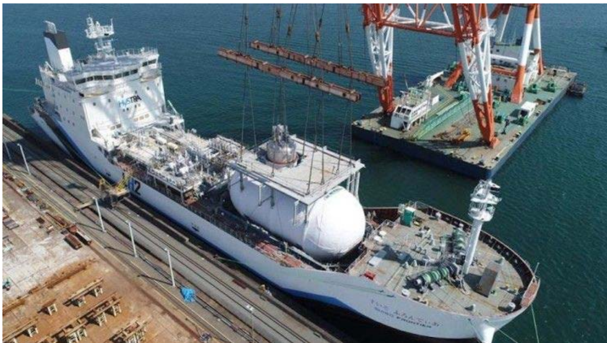
Foto nº 11. El Suiso Frontier, el primer buque en transportar hidrógeno líquido.
