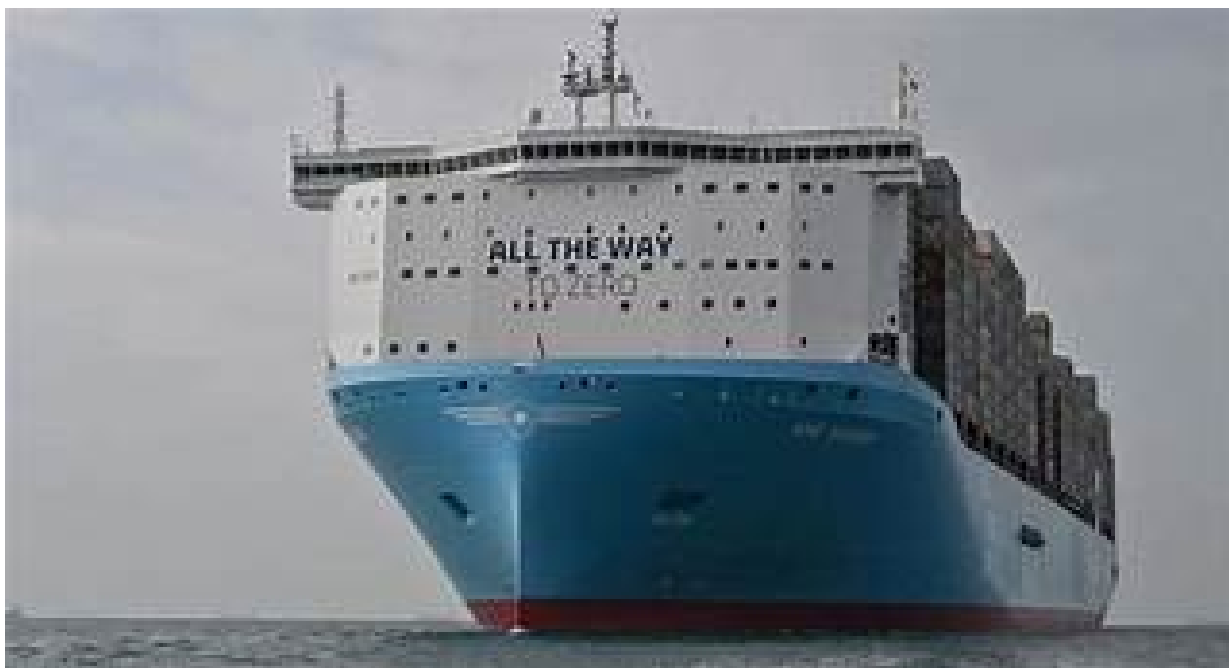
Foto nº 7. Buque propulsado por metanol. Fuente: hydrocarbonprocessing.com
