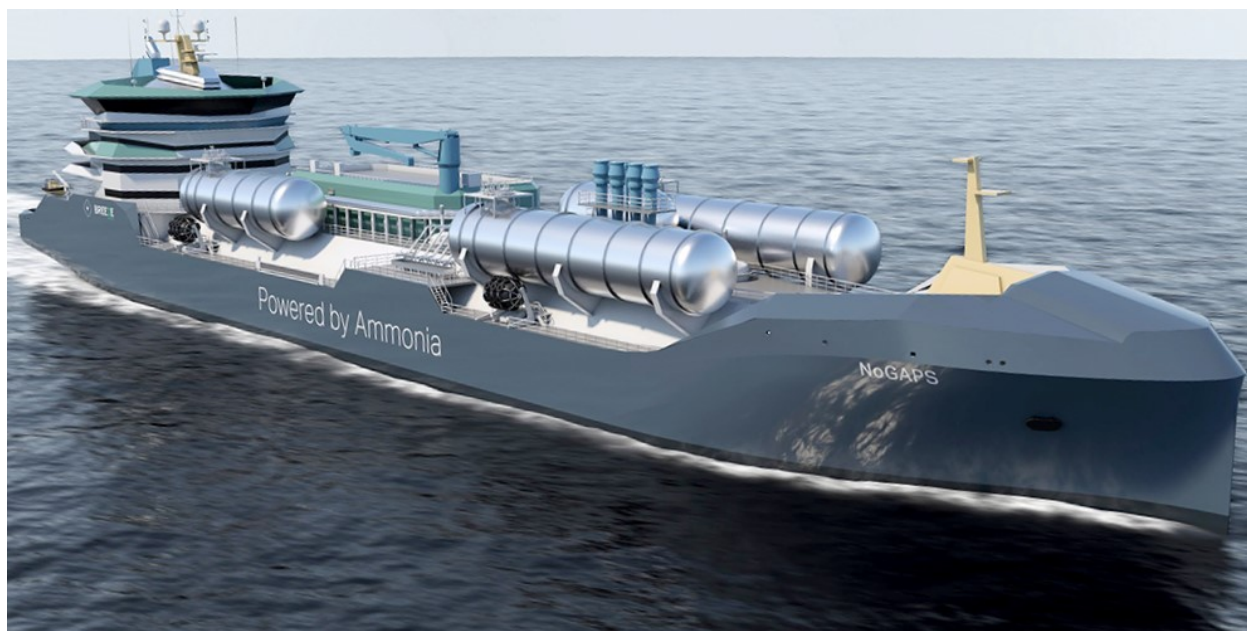
Foto nº 5. Proyecto de buque propulsado por amoníaco y tanques en cubierta
