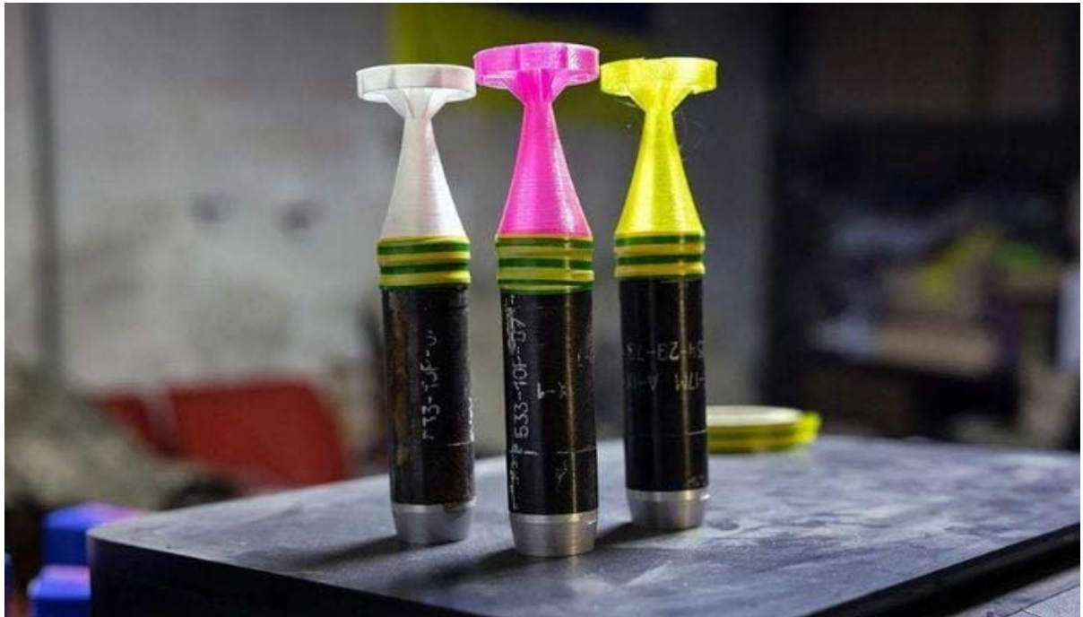
Figura 5. Aletas de explosivos impresas en 3D utilizadas en Ucrania «candy bombs». Fuente: The Economist
