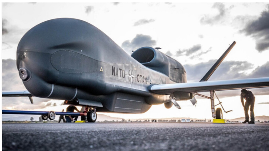
Figura 3. Alliance Ground Surveillance (AGS) RQ-4D «Phoenix». Foto OTAN
