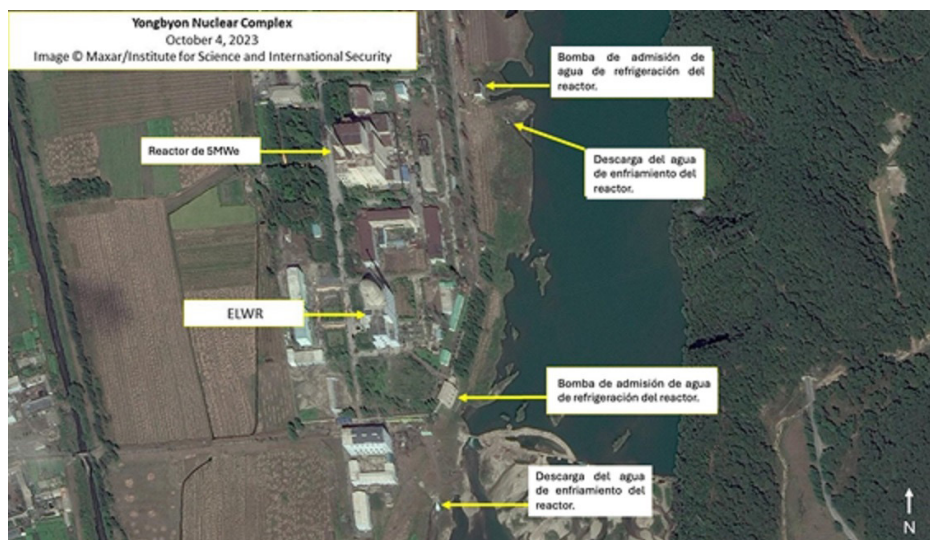
Figura 2. Análisis de la imagen del Complejo Nuclear de Yongbyon, 4 de octubre de 2023. Fuente: Albright, D., Burkhard, S., Cheng, V. y Faragasso, S. (2024). North Korea's ELWR: Finally Operational After a Long Delay. Institute for Science and International Security. Disponible en: https://isis-online.org/isis-reports/detail/north-koreas-elwr-finally-operational-after-a-long-delay/10#images
