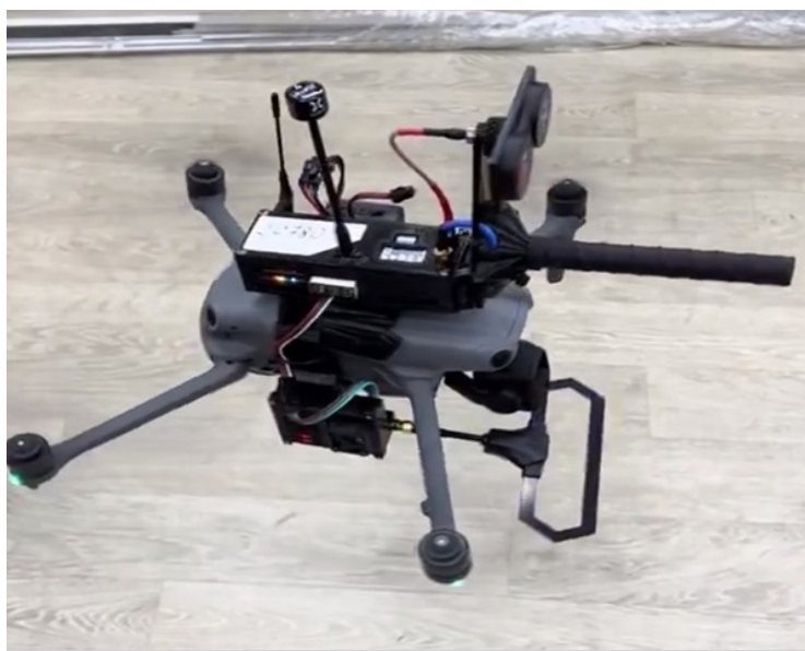
Figura 4. Sistema de relé ucraniano instalado sobre DJI mavic. https://twitter.com/front_ukrainian/status/1745906821871612023
