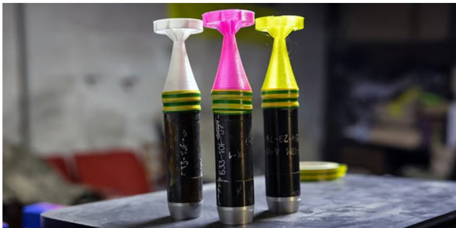
Figura 2. Granadas VOG modificadas con aletas impresas en 3D para su uso con drones. © Getty Images
