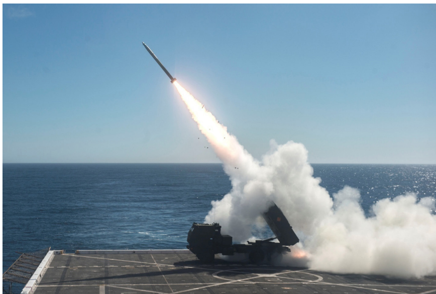
Figura 13. Empleo HIMARS desde cubierta vuelo de un patrullero estadounidense. Fuente: Cleary, 2019 89 .
