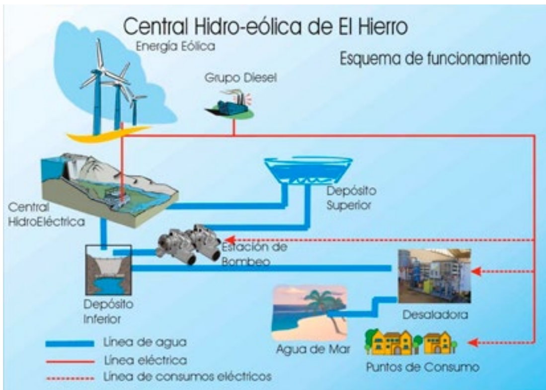
Figura 5. Esquema de funcionamiento de la central hidroeólica de Gorona del Viento. Fuente: Gobierno de Canarias.
