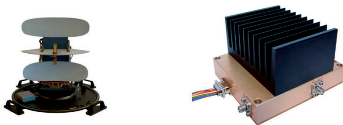
Figura 14. Radar y transmisor de estado sólido de vigilancia superficial ART Midrange. Fuente: Boletín de Observación Tecnológica en Defensa nº 44.
