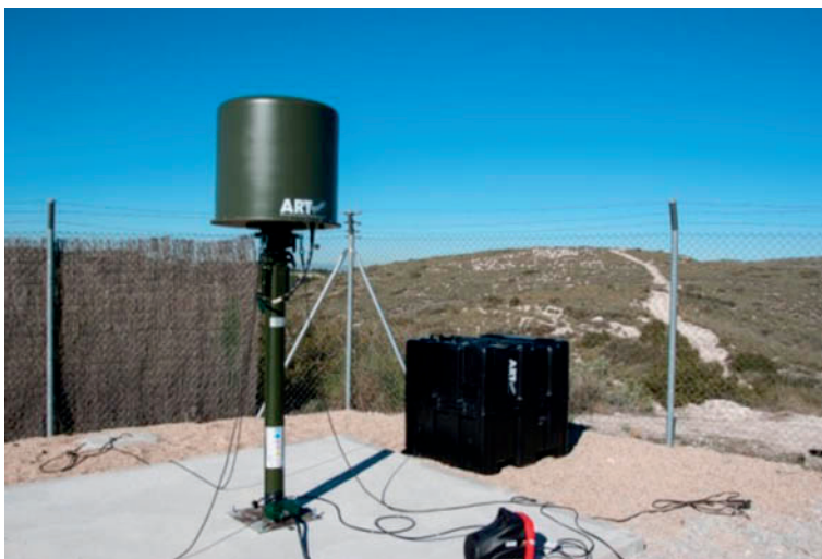
Figura 15. Instalación del radar en las instalaciones del ITM. Fuente: Boletín de Observación Tecnológica en Defensa nº44. SOPT.
