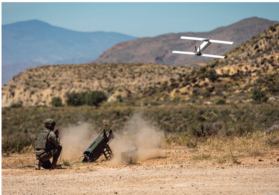
Lanzamiento de un dron del sistema merodeador Q-Slam 40 de Arquimea en la zona de pruebas del campo de maniobras Álvarez de Sotomayor de la Legión en Viator, Almería.
