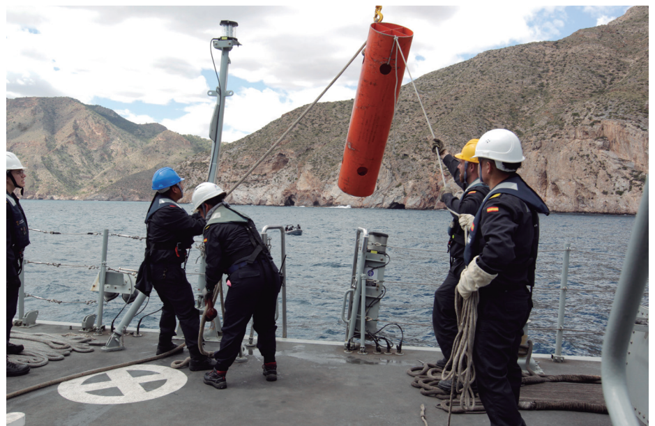
Una vez localizada, la dotación del Turia recoge la mina de tubo que buscaban y la suben a cubierta mediante los cabos que han colocado previamente los buceadores.
