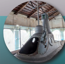
Escotilla de acceso y torreta óptica (periscopio).
