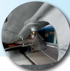
Hélice vertical Estabiliza el sumergible bajo el agua, lleva una a popa y otra a proa.
