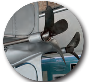
Hélices propulsoras Van unidas a sus motores eléctricos.
