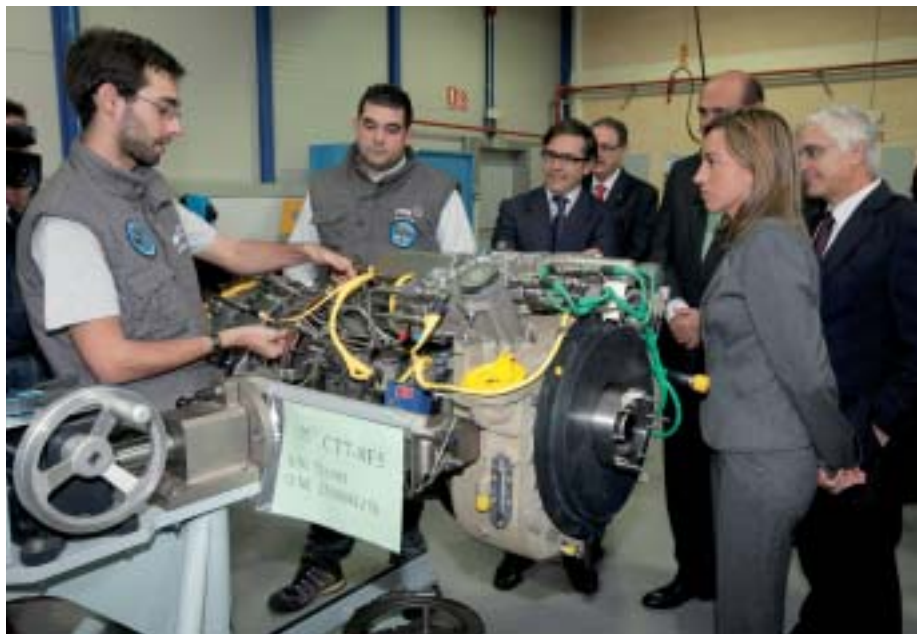
Los operarios de ITH encargados de su ensamblaje explican a Carme Chacón las características de la turbina que equipará a los helicópteros NH-90 españoles.
