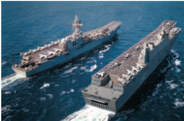
Con 10.000 toneladas de desplazamiento más que el portaaviones, el nuevo LHD le supera en casi 10 metros de altura y 36 de eslora.
