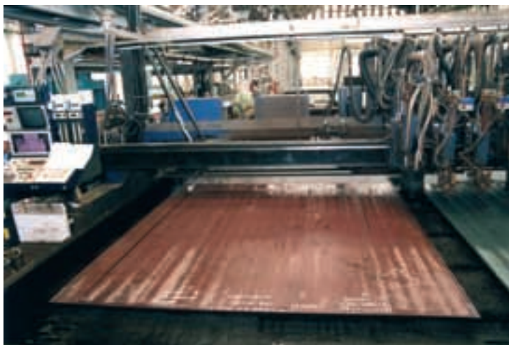
La construcción del Juan Carlos I se inició en mayo de 2005 con el corte de las primeras chapas de acero en la factoría de Navantia Ferrol.
