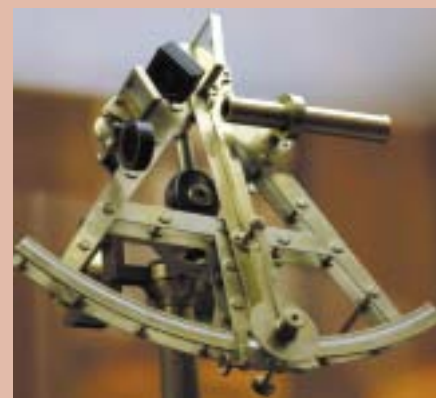
Una de las piezas que ayudan a entender la navegación de la época es este sexante, con el que se calcula la altura de los astros sobre el horizonte para fijar latitudes.
