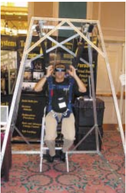
De estructura aparentemente sencilla, el simulador de apertura manual es muy fiel al emplear realidad virtual.
