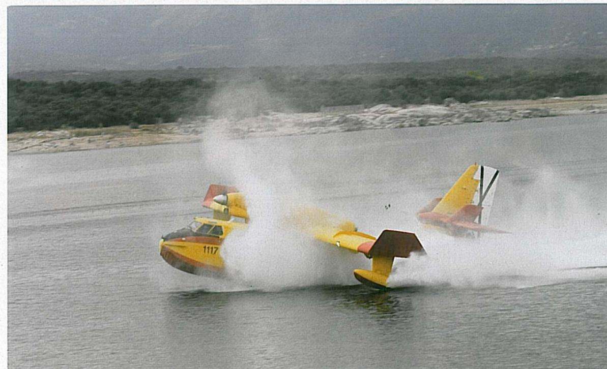
En la otra página arriba, un CL-215T se posa en el agua en un pantano. Abajo, un Canadair lanza agua sobre un incendio. Arriba, un CL-215T frena en el agua dando la reversa de sus motores.
