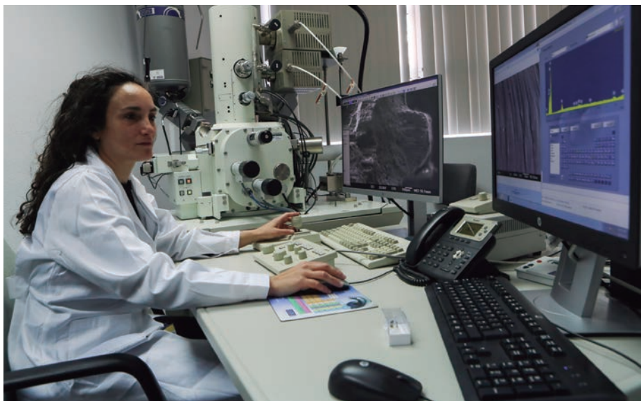
Análisis de muestras de material de una aeronave siniestrada con un microscopio electrónico de barrido por emisión de campo en un laboratorio del INTA.
