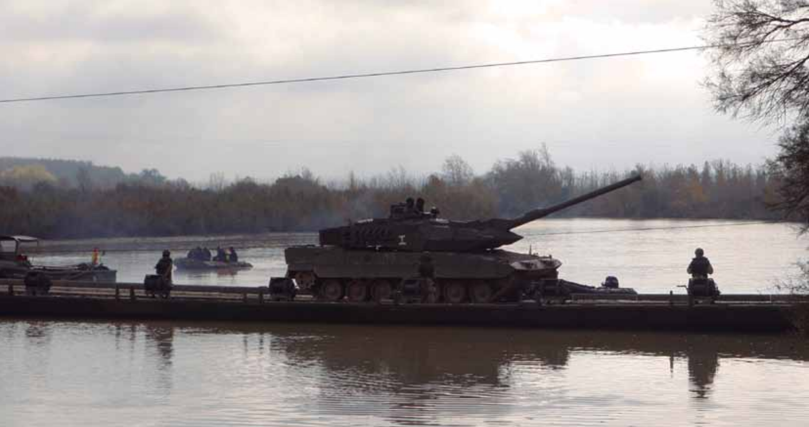
El puente instalado sobre el Ebro a su paso por Sobradiel estaba preparado para soportar pesos de hasta 80 toneladas. Las lanchas de empuje Schotel —imagen inferior derecha— proporcionan estabilidad a la plataforma frente a la fuerza de la corriente del agua.
