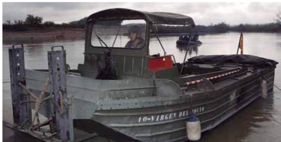
El puente instalado sobre el Ebro a su paso por Sobradiel estaba preparado para soportar pesos de hasta 80 toneladas. Las lanchas de empuje Schotel —imagen inferior derecha— proporcionan estabilidad a la plataforma frente a la fuerza de la corriente del agua.
