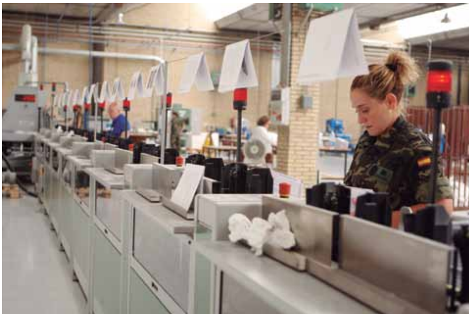
Tren de encuadernación en rústica instalado en la imprenta del Centro Geográfico del Ejército.
