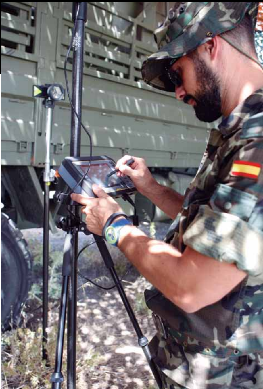
Un miembro de la UGET, con un equipo combinado con R10 V10, que permite la obtención de puntos geográficos en el campo con una gran precisión.
