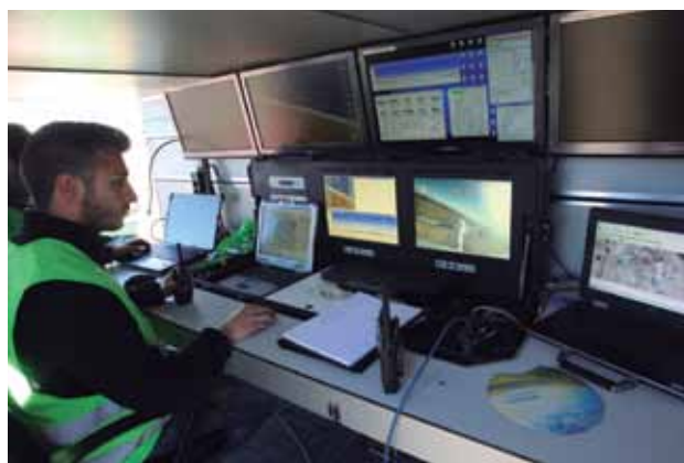
Estación de control en tierra para la monitorizaron de las imágenes proporcionadas por los UAV en Marugán.
