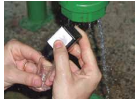
Los controles en las instalaciones de suministro de agua previenen el riesgo de legionelosis.
