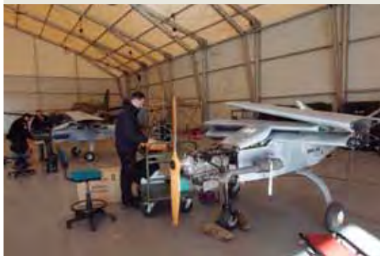
Personal del INTA realiza tareas de mantenimiento de las plataformas aéreas del SIVA en Maticán.
