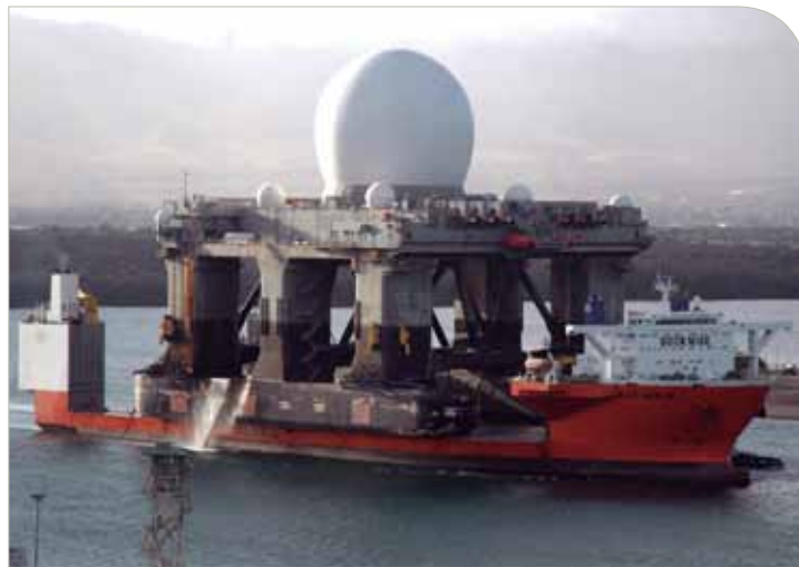
El Blue Merlin traslada una estación flotante de radar de alerta aérea temprana construida a partir de una antigua plataforma petrolífera.
